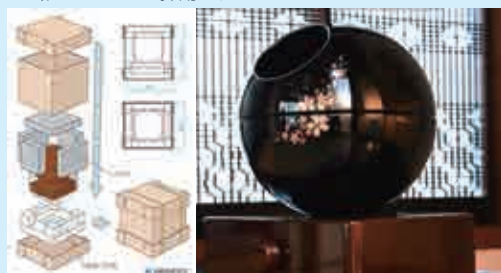
製品用途 音響機器用梱包箱 製品寸法 300×395×300 製品重量 約11.7kg 材質 段ボール (内装材/発泡材EPE38倍、ウレタン)
